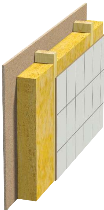
Rys. 1 Ściana wewnętrzna Skończony stelaż drewniany. Pojedyncza płyta.
