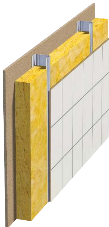
Rys. 5 Ściana wewnętrzna Skończony stelaż stalowy. Pojedyncza płyta.
