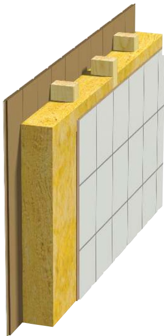
Rys. 2 Ściana wewnętrzna Offset elementów stelaża drewnianego na podwalinie drewnianej. Pojedyncza płyta.
