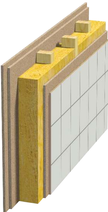
Rys. 3 Ściana wewnętrzna Offset elementów stelaża drewnianego na podwalinie drewnianej. Płyty podwójne.
